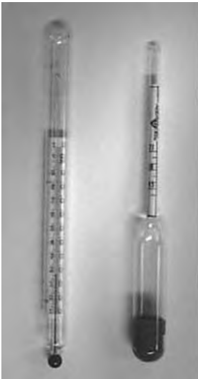
Figuur 5.2 Areometer met bijbehorende thermometer.
